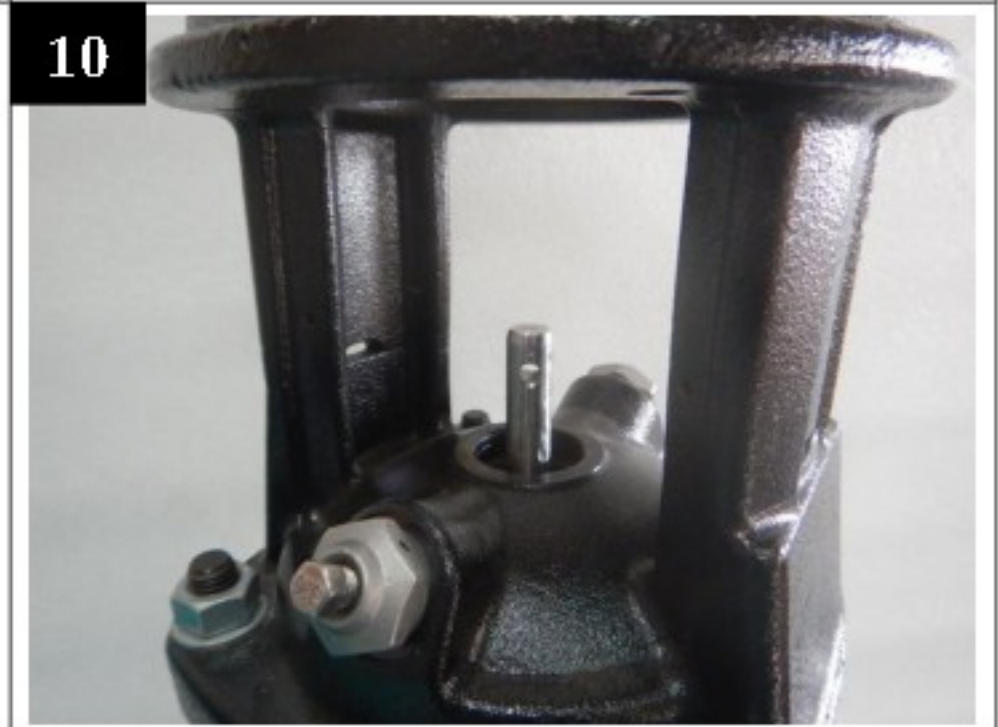
軸封組拆解完成
