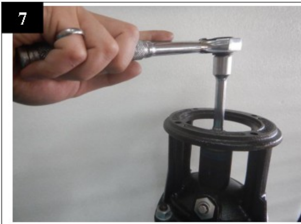
拆下泵頭上軸封組
