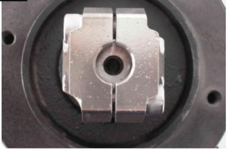
使聯軸器組兩側間隙寬度調整成一致
